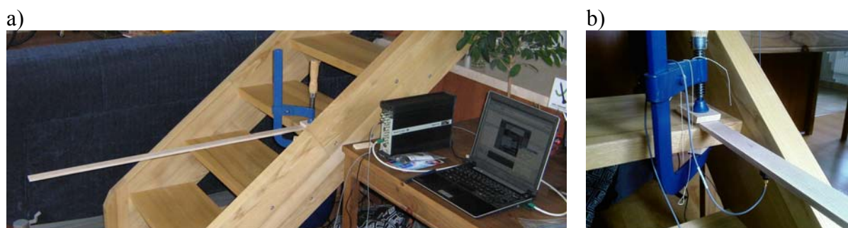
Obr. 1 Dřevěný konzolový nosník: a) testovací konfigurace, b) realizace vetknutí
