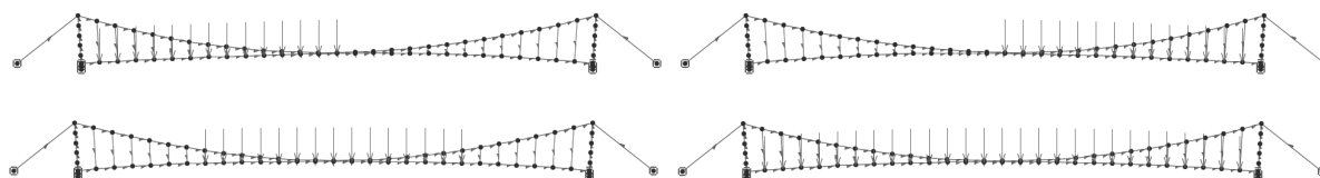
Obr. 4.8: Jednotlivé zatěžovací stavy (zatížení levé, pravé, prostřední a plné)
